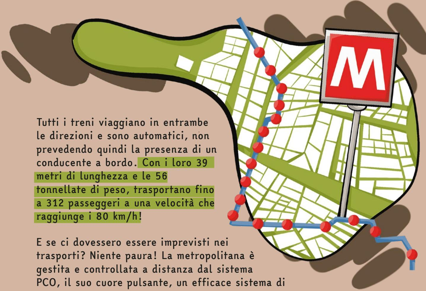
Tutti i treni viaggiano in entrambe le direzioni e sono automatici, non prevedendo quindi la presenza di un conducente a bordo. Con i loro 39 metri di lunghezza e le 56 tonnellate di peso, trasportano fino a 312 passeggeri a una velocità che raggiunge i 80 km/h!
